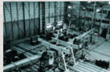
▲多軸電気・油圧サーボ試験機
