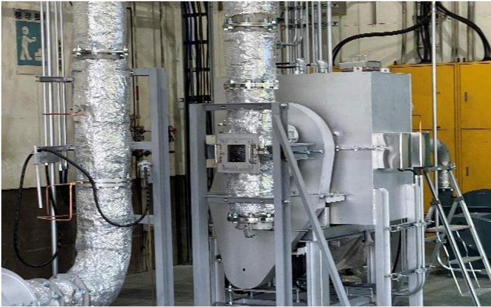
《 有機分解処理を行う「炉」の部分 》
