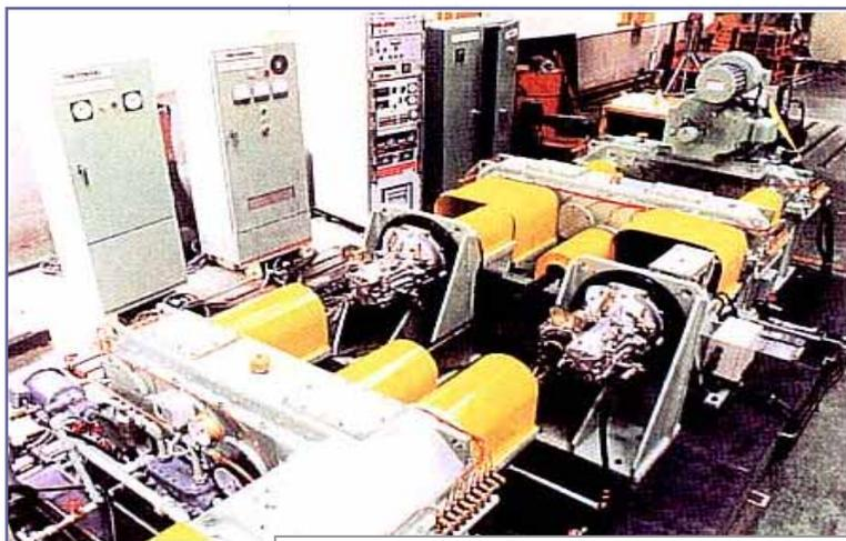
動力循環式トランスミッション耐久試験装置
