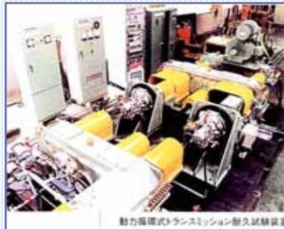
動力循環式トランスミッション耐久試験装置
